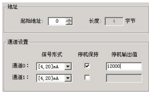
图 4-9 AO 模块参数配置
