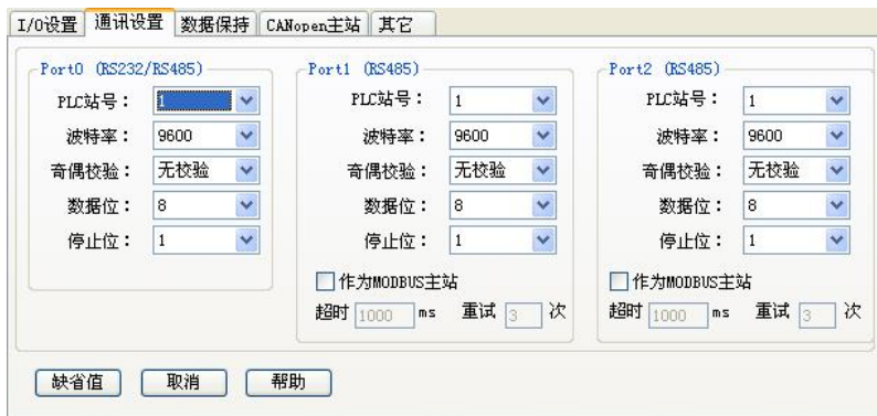
图 4-4 【通讯设置】参数配置页面
