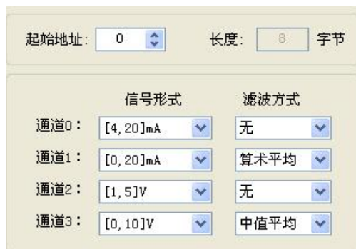
图 4-8 AI 模块参数配置
